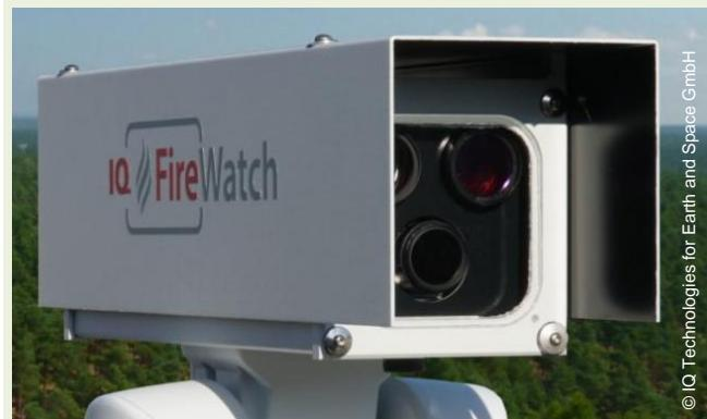
**Die Überwachung funktioniert so:** Die Sensoren erkennen die typischen Grauwerte einer Rauchwolke in der Frühphase eines Brandes über große Entfernen.
