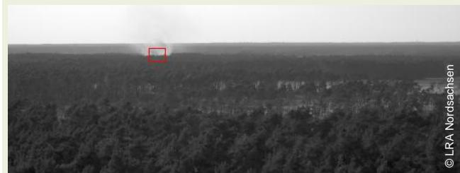
**Das Kamerasytem** detektiert automatisch kritische Situationen und sendet eine Verdachtsmeldung an die nächste Waldbrandzentrale. Dort überprüft ein Mitarbeiter, ob es tatsächlich brennt. Überwacht wird von März bis September, ab Waldbrandgefahreinstufe 2 zwischen 10 – 20 Uhr im Radius von 15-20 km.
